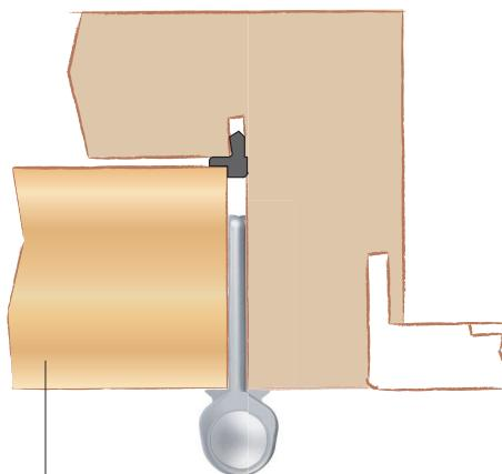
Spessore minimo dell'anta: 35 mm.
