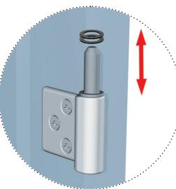
In fase di installazione, le rondelle permettono di regolare in altezza l'anta.
