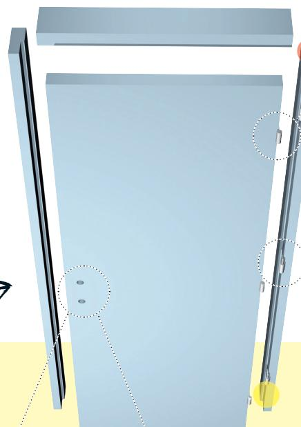
Vite da fissare in funzione della mano e dello spessore porta.
