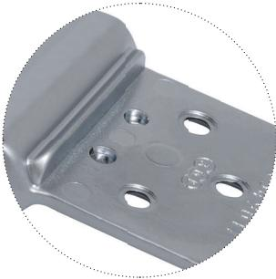
L'installazione di Twin non richiede fresate. La battuta dell'aletta funge da autodima e garantisce sempre il posizionamento preciso della cerniera.
